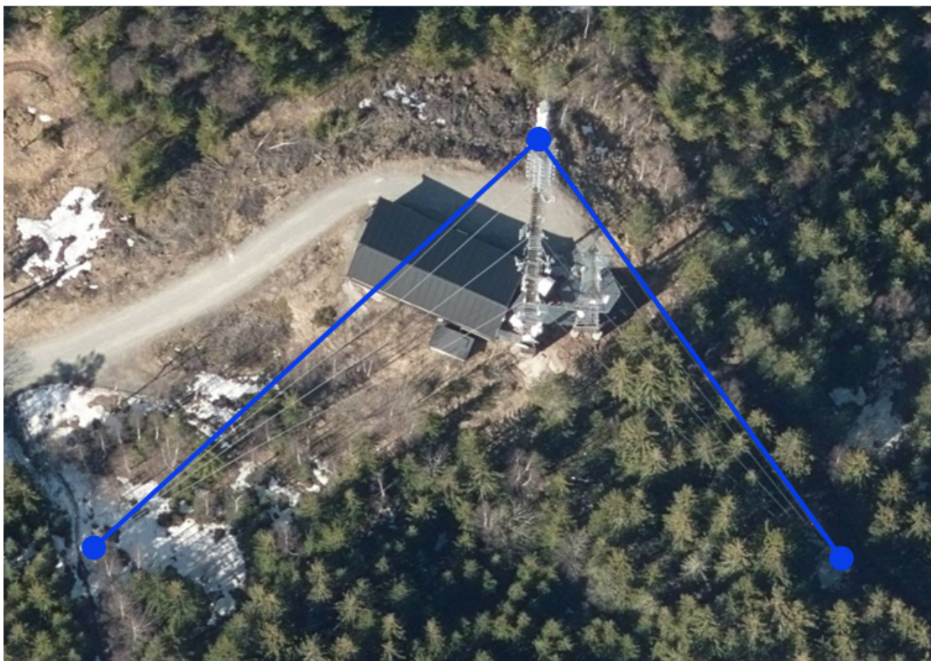
Figur 2. Dersom flere barduner går i samme retning skal den høyeste og lengste bardunen registreres.
